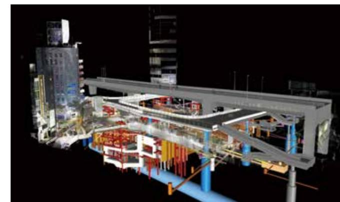
地下構造物では、詳細設計段階でBIM/CIMを活用することが修正設計などの負荷低減につながる。(画像提供: 東急建設株)
