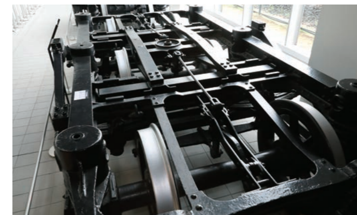
上／明治26(1893)年に横川～軽井沢間に開通した碓氷線の碓氷第三橋梁。同線はアプト式の登坂機構で急勾配の峠を越え、生糸や繭の輸送ルートになった。 下／車輪幅が狭軌、標準軌に変更できる台車。「台車の幅はそのままどちらにも対応できる。結局日の目を見ませんでした。論争の象徴として展示しています」(大信田館長)
