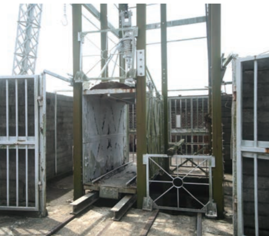
第二堅坑の坑口。炭鉱マンはここから地下160mまでケージを使って昇降した。坑道は地下約600mまで広がっているが現在はほとんどが水没している。
