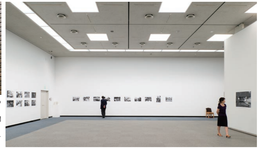
右／企画展示室。3つの企画展示室があり、一つは天井高を高く設定されている。ポストテンション梁を採用することで途中に柱の無い大きな空間を生み出している。 上／緊張させた梁端部の所在を意匠としても表している。
