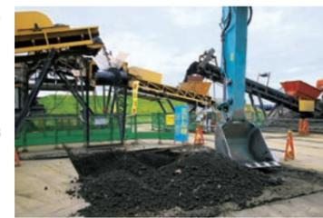
と太田所長は話す。さらに「歩留り」という大きなハードルがあった。堆積土砂の八〇%以上を客土材に仕上げる。工事契約時から必須事項として課せられた条件だった。「二〇〇立方メートルの土砂から五〇立方メートルの客土材しか取れないなら他所から買ってきた方が安くあがります。それではこの事業の意味がなくなってしまう」。土砂の含水比の管理も課題になった。水分を多く含んだ土砂は容易に選別できない。機械の故障にもつながる重
