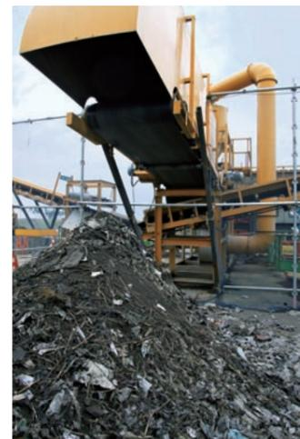
選別されたガレキには金属片、木片、ガラス、プラスチックなどが混入している。ふるい機は見た目よりも繊細だ。土砂の扱いには神経を配り、自ずと操作も慎重になる。
