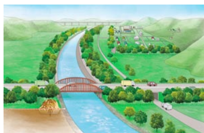
河川の堤防や、かさ上げした道路のり面に植樹して緑の防潮堤にする。また、高台に造成した宅地のり面にも植樹することで、減災を目指す。
