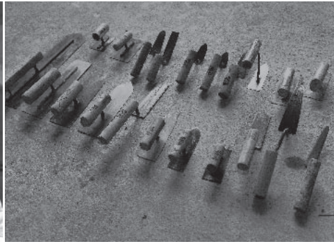
左/柱表面の仕上がりをチェックする。「2mmと言われれば2mmで、1cmと言われれば1cmで塗れます。これはもう感覚としが言いようがないです」 右/狭いところ、広いところ、隣の建物との隙間…塗る場所によって無数の鏝を使い分ける。
