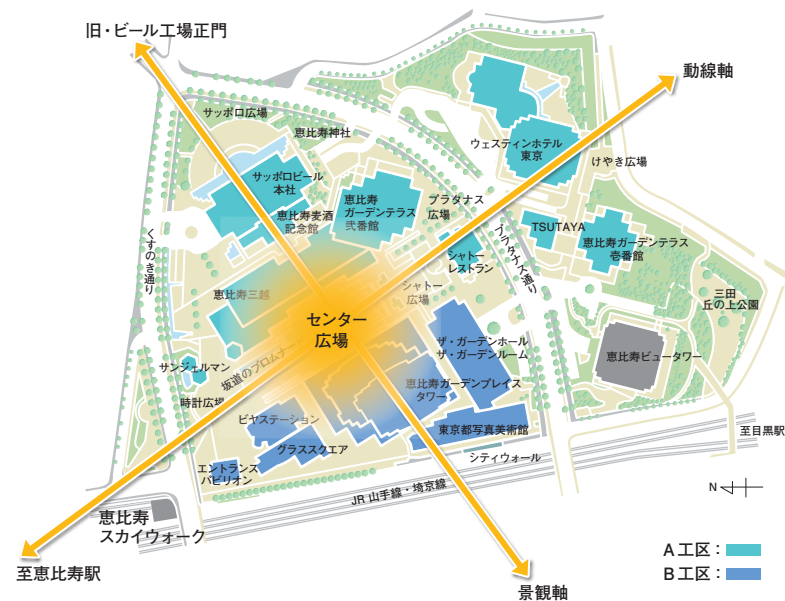
施工はA工区・B工区に分割して行われた。くすのき通りとプラタナス通りは都市計画道路として整備された。各棟は地下通路で結ばれている。
