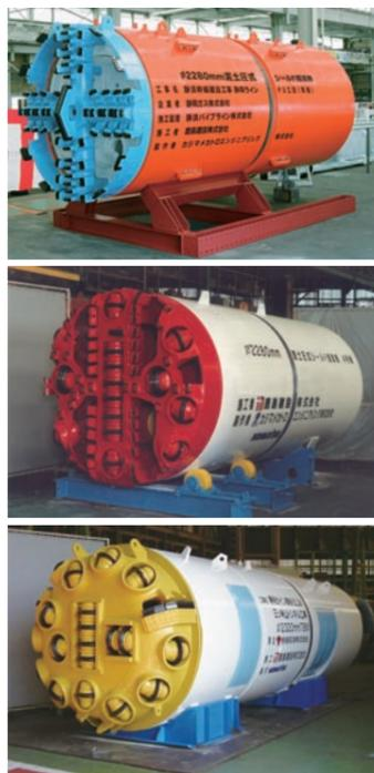
シールドマシンは、施工ポイントの地質に合わせて、土砂対応のスポークタイプ(上)と、砂礫、玉石対応のドームタイプ(中)の2タイプを採用した。下は日本坂トンネルの掘削に投入された岩盤専用の掘削機TBM。(提供：鹿島建設(株))
