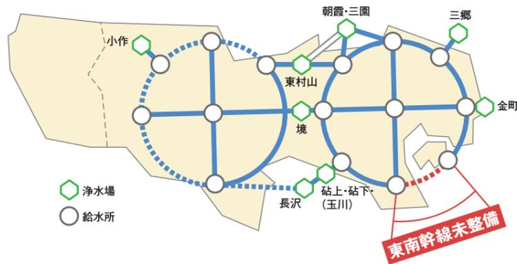
東京都全域を送水幹線の「丸めがね」で包囲し、さらに拠点となる給水所を縦横に結ぶ壮大な計画。災害時、補修時に遠隔地間の水の融通を可能とする。
