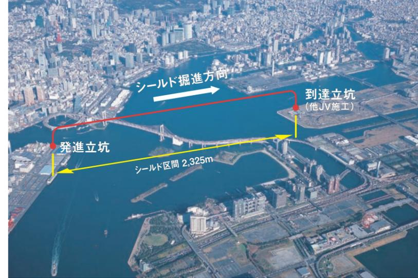
品川埠頭に発進立坑を構築し、ここから掘進を開始。レインボーブリッジも越え、初めて水道幹線が海を渡った。約2.3km対岸の到達点、豊洲埠頭では三郷浄水場から延びる管路が待っている。
