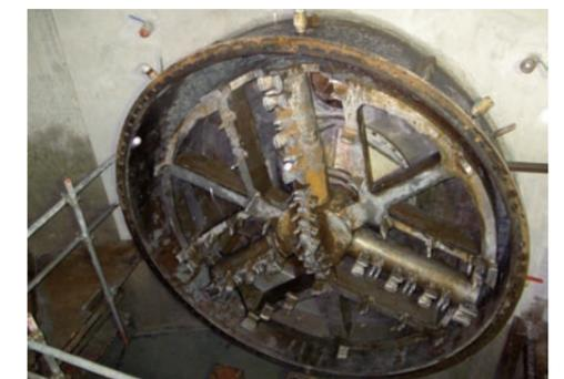
粘性の高い掘削土砂を排出し易いようにシールドの面板の取込み口を大きくした。扉の写真(稼働前)と比較するとその工夫の跡がよくわかる。掘進状況はGPS、ジャイロコンパスを用いて常時確認、誤差は30mmの範囲に抑えた。
