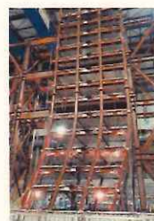
図表4 「都市の脆弱性が引き起こす激甚災害の軽減化プロジェクト」による振動台実験(H26.5文部科学省他報告書)
