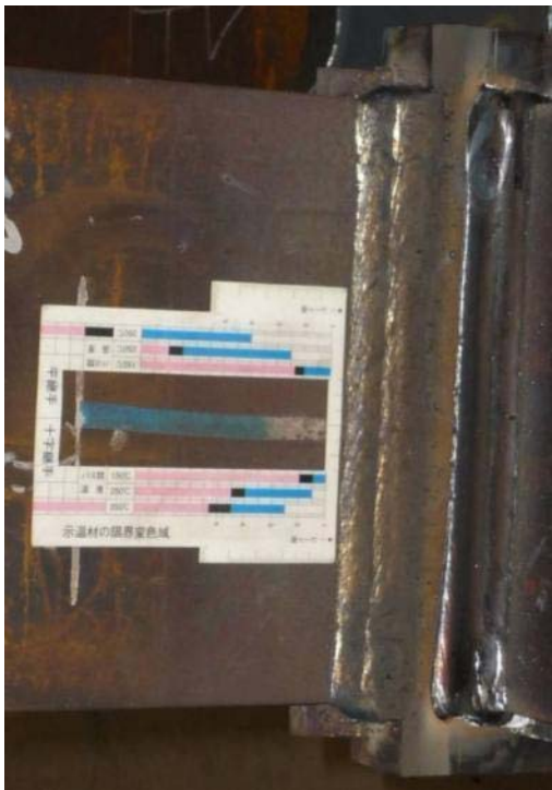
示温塗料を塗布した使用事例
