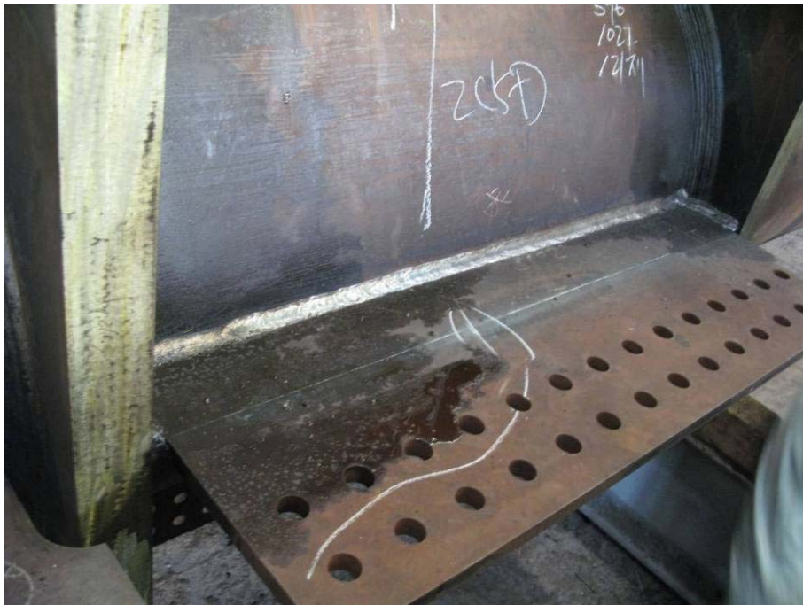
スパッタ付着防止剤が塗布された摩擦面
