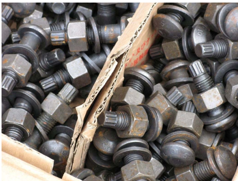
さびた高力ボルト
