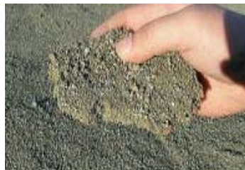
土壌固化状況
