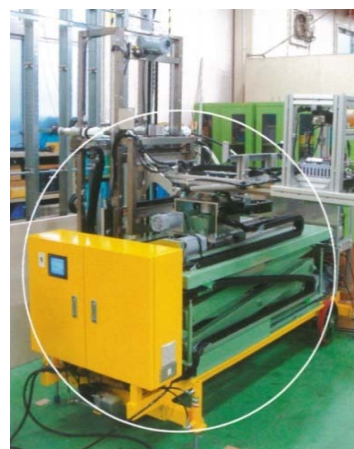
リフターをたたみ壁面下部へのボード張り
