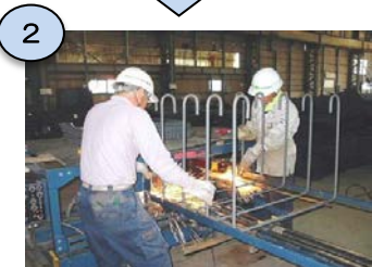
使用鉄筋と段取り筋をスポット溶接
