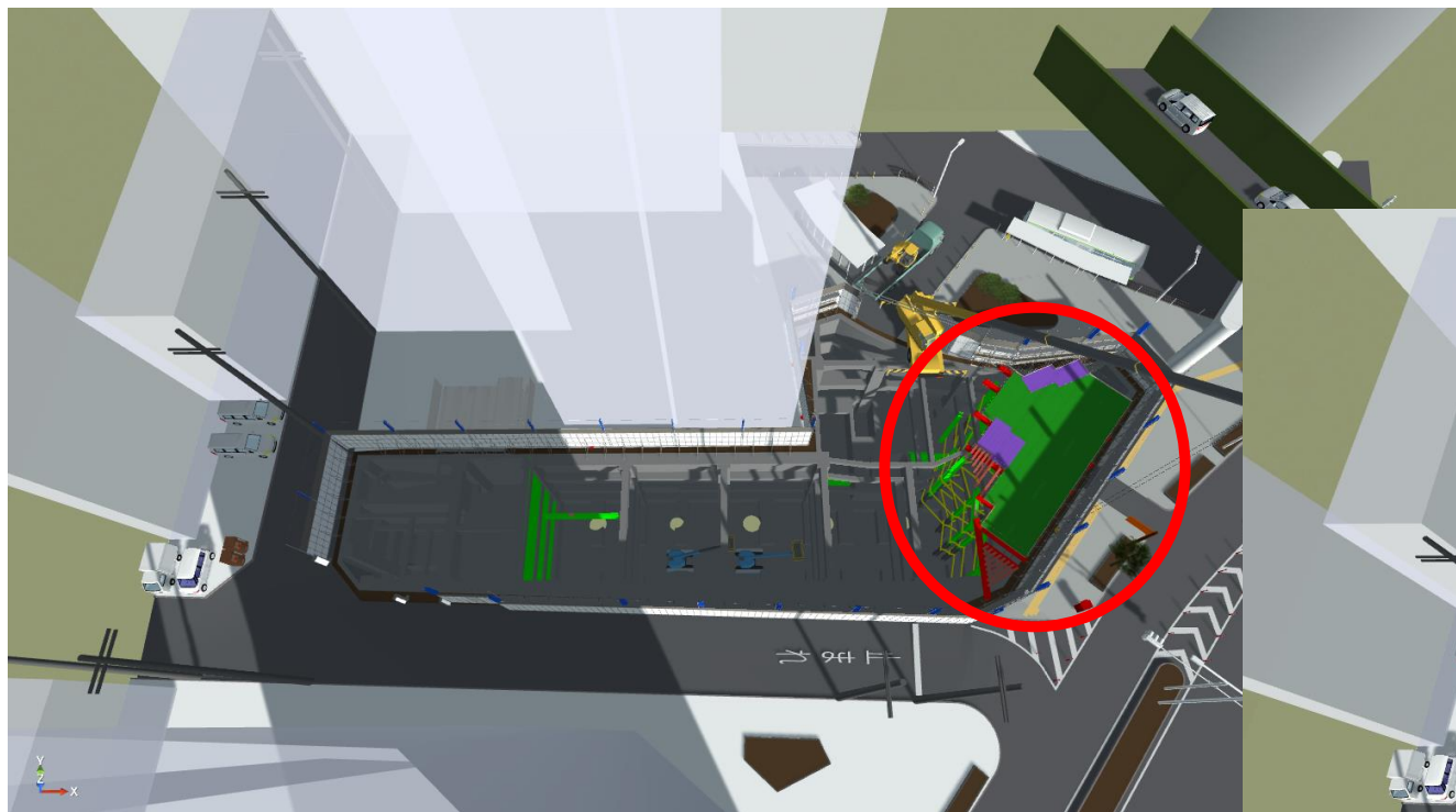
1工区構台組立て
