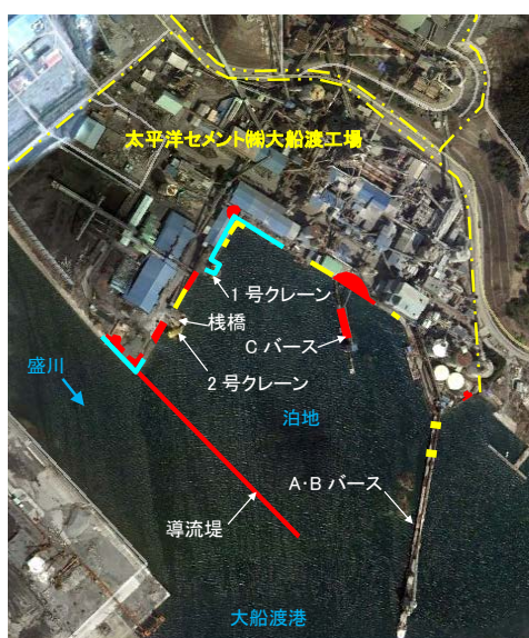
【凡例】 ■ 崩壊箇所(護岸・導流堤・栈橋) ■ 海中洗掘箇所(護岸捨石、バース基 ■ 満潮時護岸背後没水箇所
