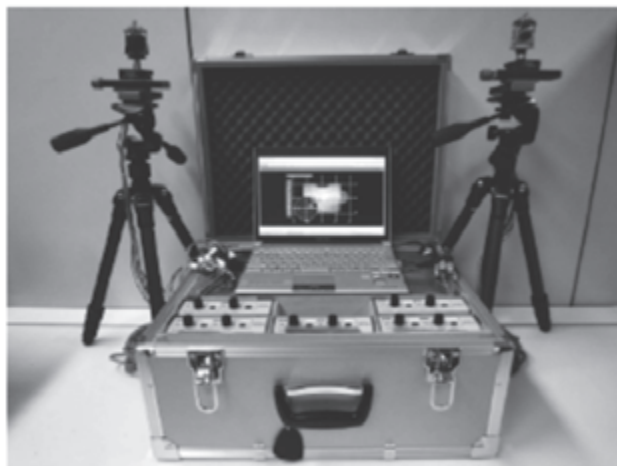
写真-2 音源距離推定装置（前景）
