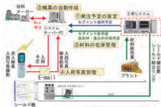
図-8 資材管理システムと受入検査管理システムの連携
