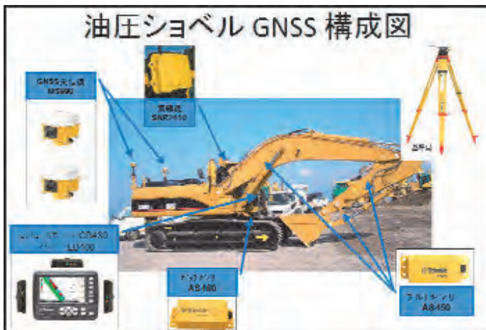
図-3 マシンガイダンス（バックホウ）機器構成
