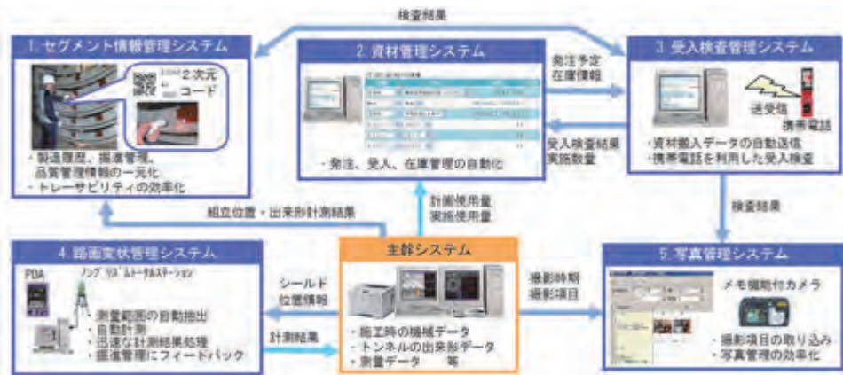
図-1 シールド情報統合管理システム
