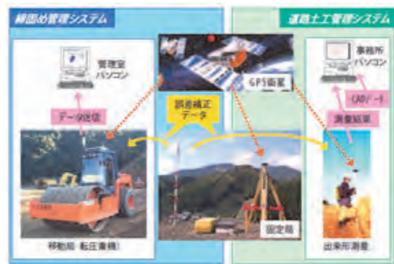
図-5 統合したシステムの構成
