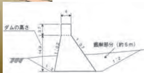
図-4 越流部の標準断面図
