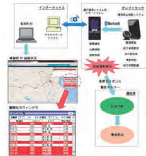
図-1 衝突防止支援システム 概要図
