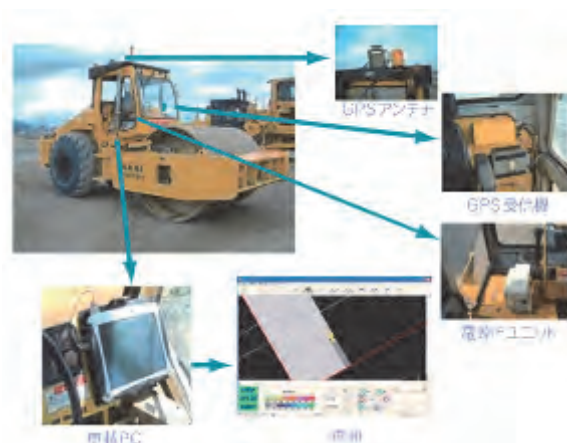
図-3 システム構成 (振動ローラ)
