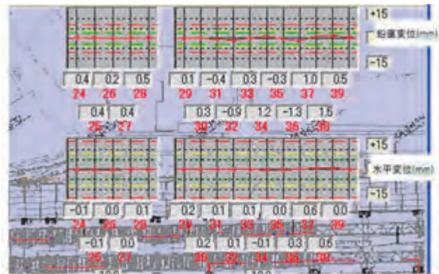
図-4 軌道計測画面例
