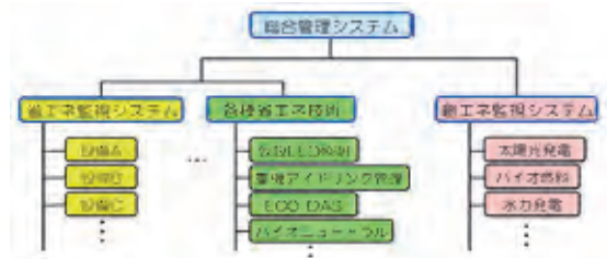
図-1 スマートサイトシステムの構成
