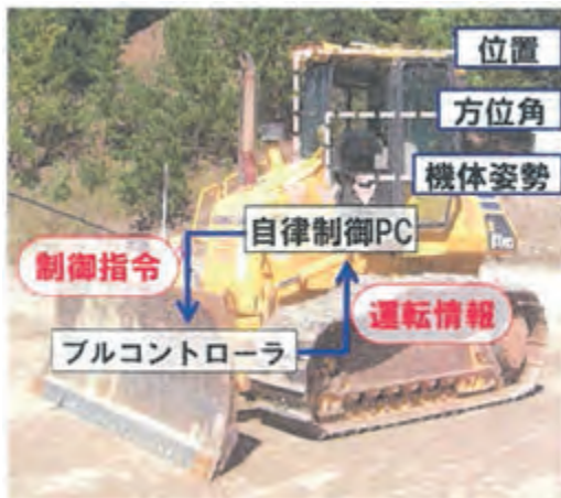
図-5 自動ブルドーザのシステム構成
