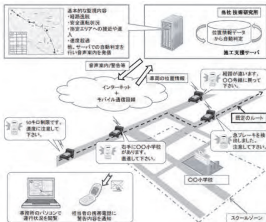
図-2 移動体管理システムの例(工事車両の運行管理システム)
