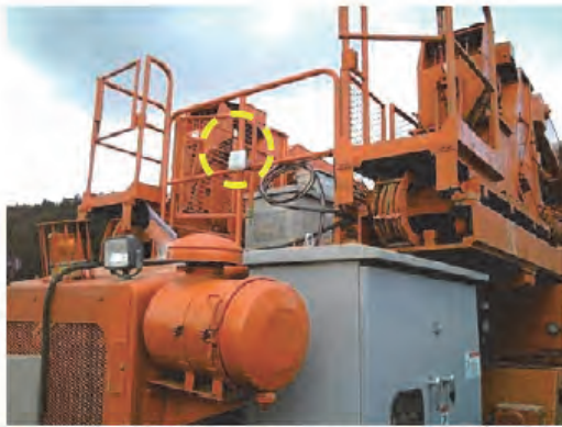
写真-9 データ伝送用アンテナ（ジャンボ搭載）
