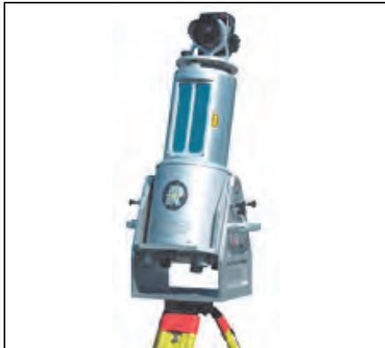
写真-1 RIEGL 社製 LMS-Z360i
