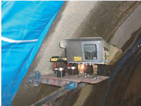
写真-1 三方向レーザ変位計
