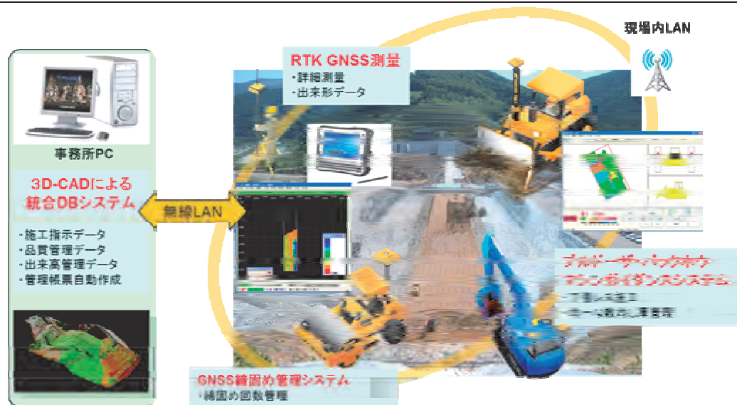
図-1 ICT 土工管理システムの概図
