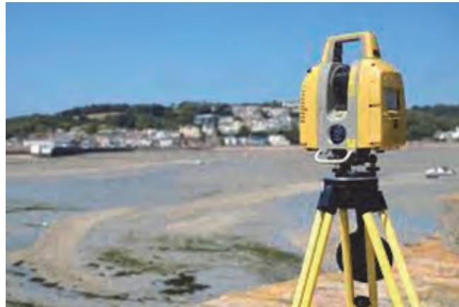
図-7.2.5 3D レーザスキャナを利用いた計測
