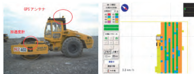
図-4 振動ローラ転圧管理システム
