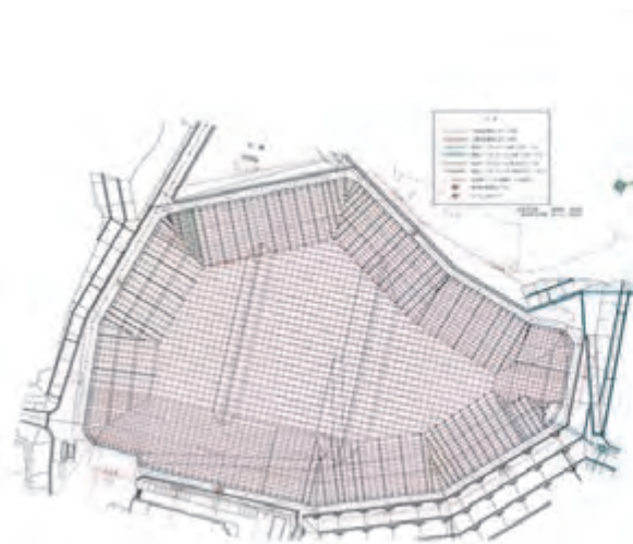
図-2 測定電極敷設平面図
