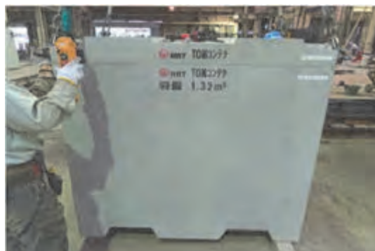
写真-4 RFIDタグを埋込んだTOMコンテナ
