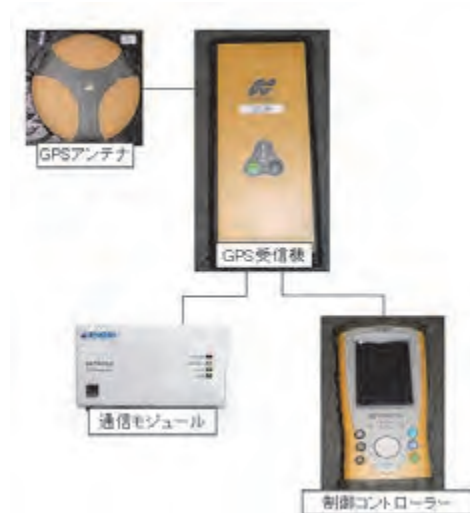
図-2 VRS-GPS の機材構成
