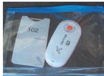
写真-2 IC タグ(左) GPS ロガー(右)
