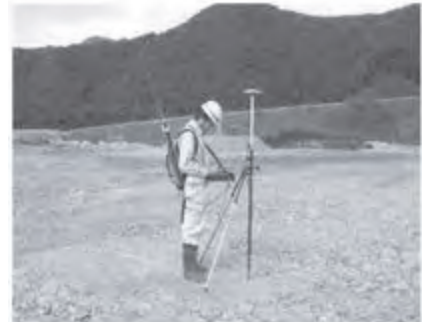
図-2 3D-Navi による測量状況
