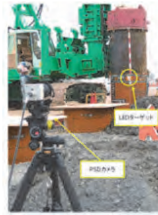
写真-1 計測状況 (PSD カメラ)
