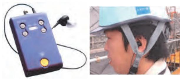
写真-3 抑制型イヤホンマイクと装着状況
