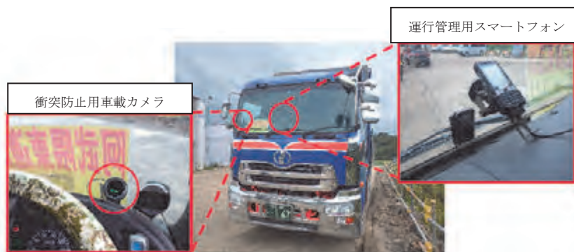
図-5 衝突防止支援システム 設置状況
