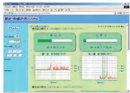
写真-6 騒音・粉塵計測データ一例
