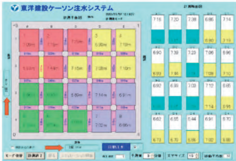
図-4 注水管理サブシステム図
