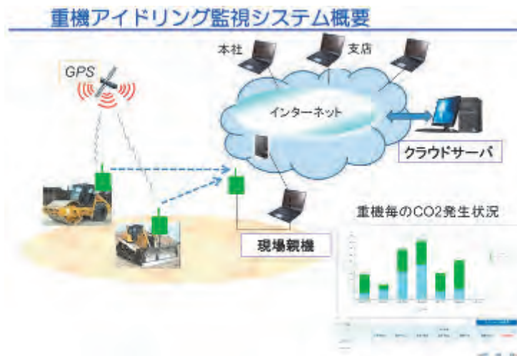
図-1 重機アイドリング監視システム概要
