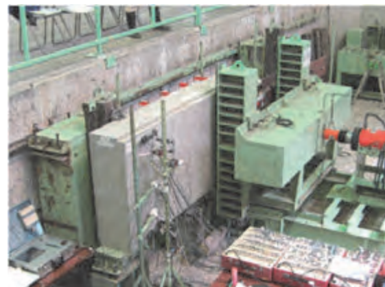
写真-4 荷重試験によるセンサ RFID の確認試験状況
