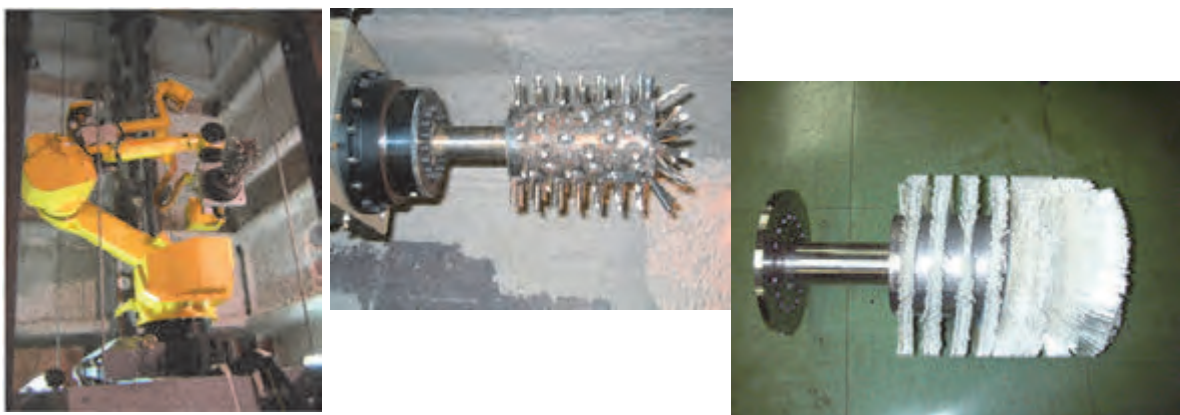
写真-3 エレベータシャフト用ロボットとアタッチメント
