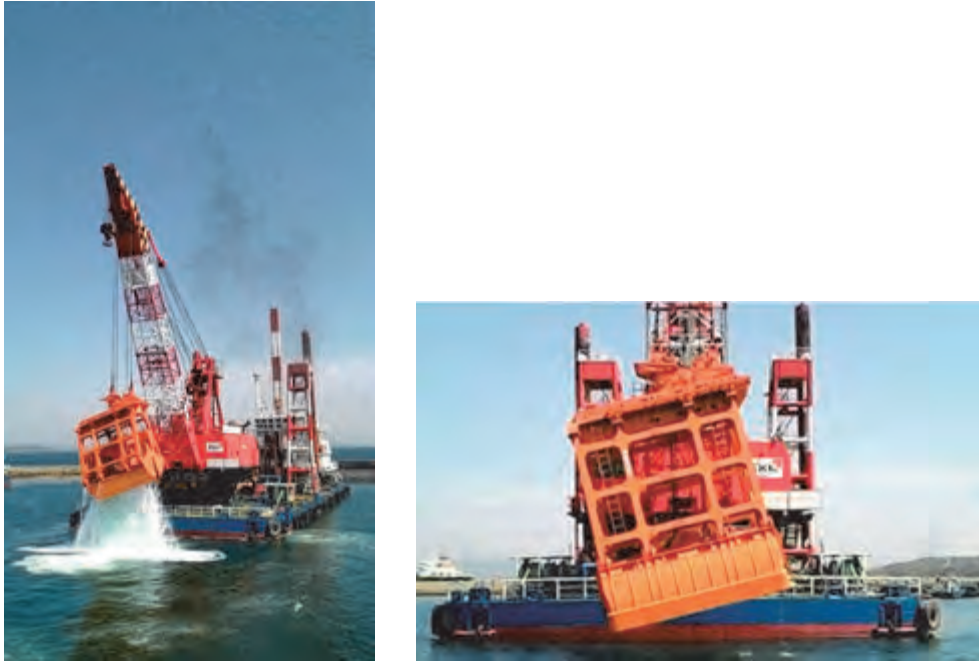
図-3 3D バケット使用イメージ
