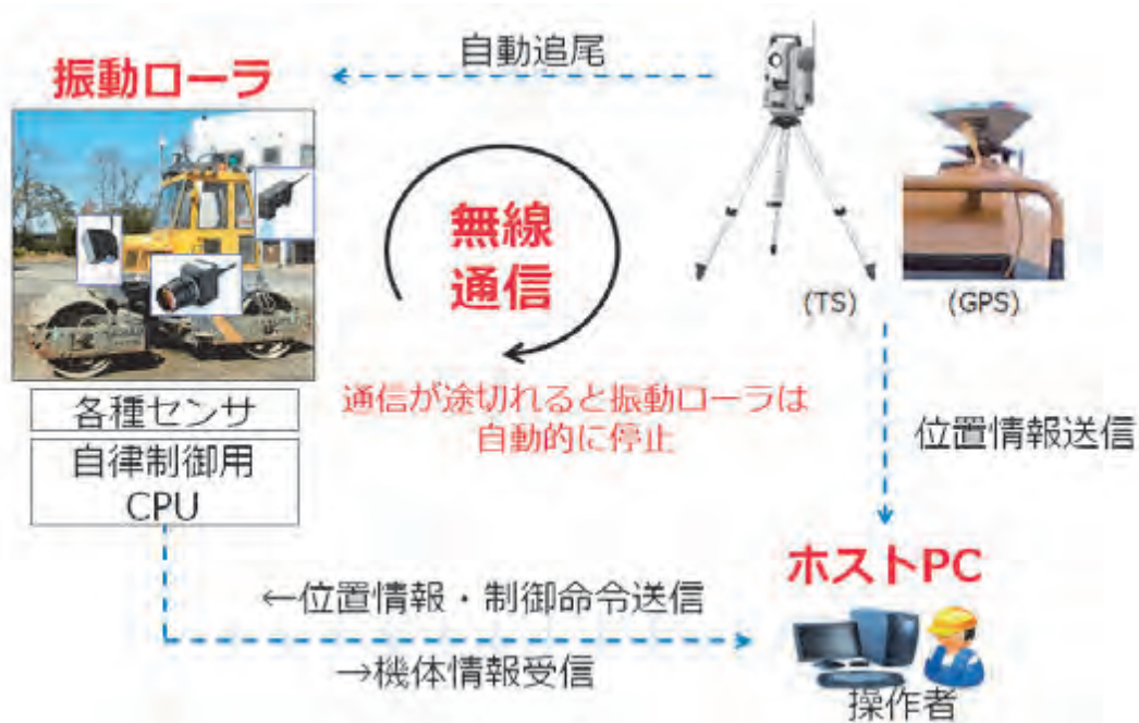
図-2 無人化施工システム
