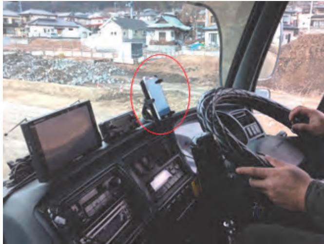
図-3 ダンプへのシステム搭載状況
