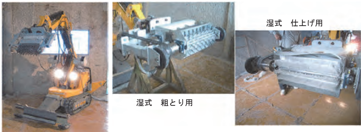
写真-2 乾式用アタッチメント(高圧水除去)と湿式用アタッチメント(回転式剥離機)
