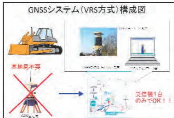
図-4 GNSS (VRS 方式) 機器構成
