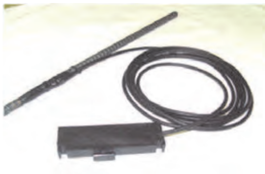
写真-3 ひずみセンサ部と RFID タグ
