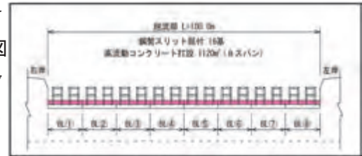
図-3 鋼製スリット堰堤正面図
