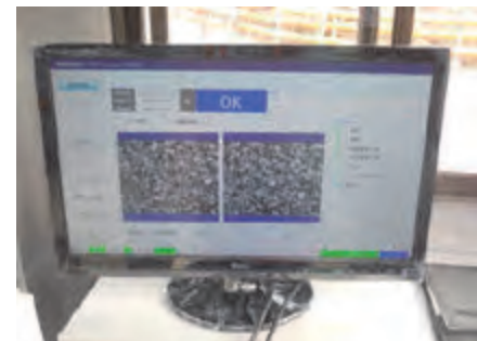
写真-2 骨材粒径の判別モニタ画像
