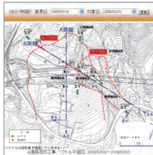
図-4 変位ベクトル平面図の表示
