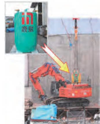
図-4 遠隔給油システム
