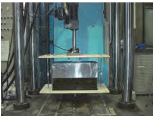
写真-3 管理基準値設定のための生物実験 (水槽内の貝に加振器で振動を与え影響を判定)
