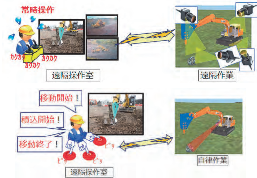
図-1 従来の遠隔操作(上) 無人化施工(下)
