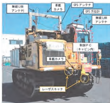
図-3 クローラダンプへの自動化機器の実装
