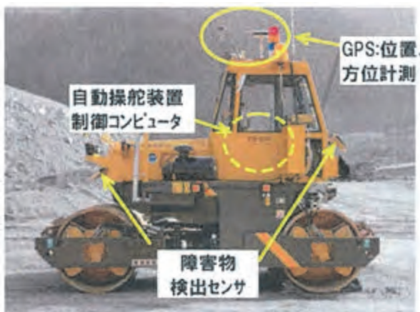
図-3 自動化装備した振動ローラ
