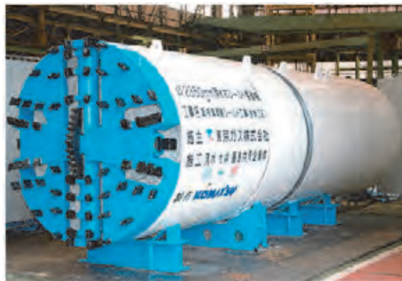
写真-1 シールド機（中折れ有り）
