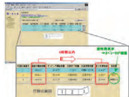
図-2 打込み時間管理図面
