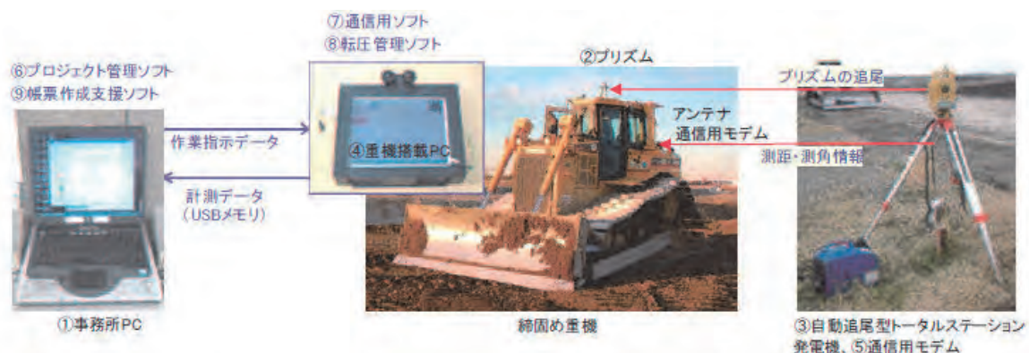
図-1 システム構成図
