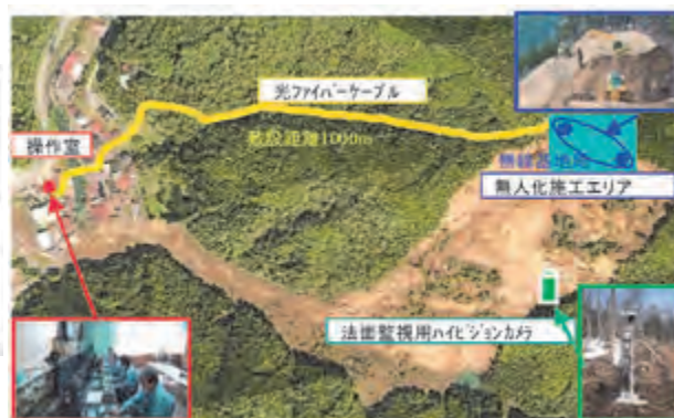
図-4 無人化施工現場配置図
