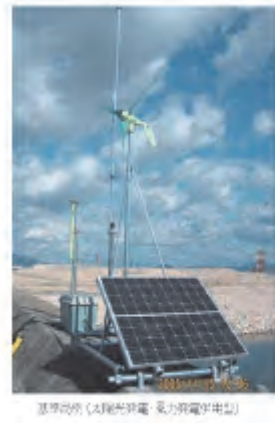
図-5 GPS 基地局構成
