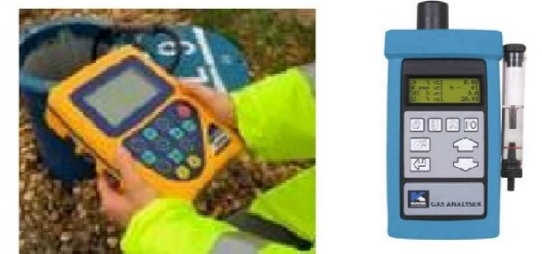
図 9. ガス検知器による有害ガスの測定
