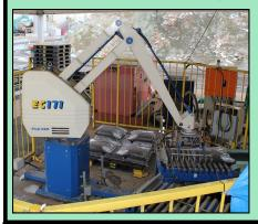
抑え、 た家畜のえさ)があります。 してくれているのが写真のロボットパレタ 腐敗臭があるので袋詰め加工をして臭気を フォークリフトで を処理する能力を備えて していますが、 当業務では多種多様な災害廃棄物を処 パレットに袋を整然と積み重ねる作業を パレットという運搬台に積み重ね、 運搬を容易にしています。 ドに運び焼却処理していますが、 最大で1時間あたり800袋 その一つに廃飼料 トラックに積んで焼却 。廃飼料は強い廃飼料(腐敗し 袋詰め後 ے
