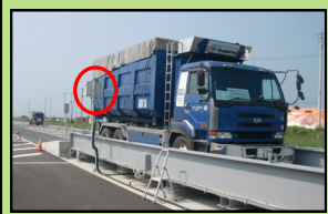
仙台市へ向かう廃棄物の重量を計測するトラック。広域処理の際は、ゲートモニター（写真赤丸部分）で放射線量も計測しています。
