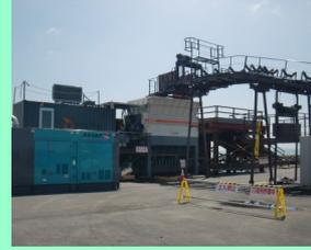
③粗選別された廃棄物はデンマーク製の高性能破砕機 (MJ6000) により30cm以下に破砕されます。
