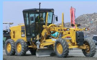
場内舗装・道路工事等での路床・路盤の整地や除雪作業などに使用され、精度の高い場に仕上げに適用されています。当現場にも計4台が導入され約25万㎡の路盤工が完了しています。
