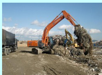
漁網の積込状況。通常の破碎機では歯に絡んで処理できないため、デンマーク製の高性能破碎機を導入する予定です。
