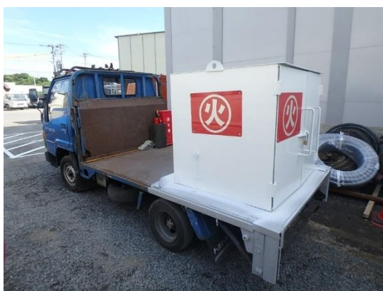
写真-12 火薬運搬車
