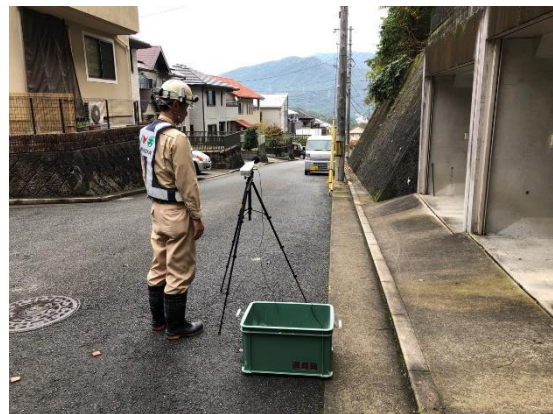
振動騒音手動計測状況
