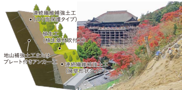
▲ジオファイバー工法
