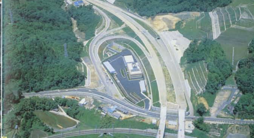
6 関西電力赤穂発電所 兵庫県赤穂市加里屋 用地造成約48万 \text{m}^2 、諸工事に伴い発生する約85万 \text{m}^3 の土砂を利用、構内の敷地造成と放水路の埋戻しをし、5,000tタンカー2隻が同時に接岸できる揚油岸壁と45,000 \text{k}^2 の重原油タンク4基、7,000 \text{m}^3 の原水タンク3基を設置。総出力120万kw
