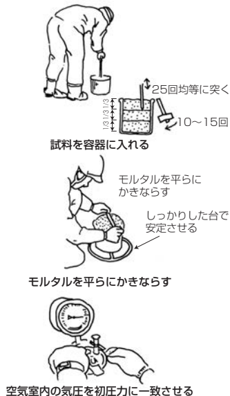
図2 コンクリートの試し練り
